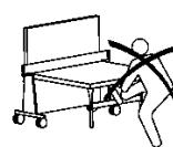
Nicht an der Querstange abstützen oder an den Füßen, um am roten Entriegelungsgriff zu ziehen.
